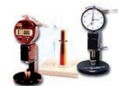
Fig. 12. Los micrómetros se utilizan para medir la anchura de la pala
