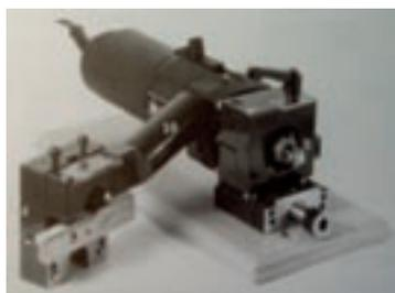
Fig. 14. Partes de la máquina de gubiar cañas eléctrica
