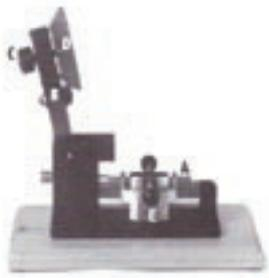
Fig. 21. Máquina de dar forma a las palas:
