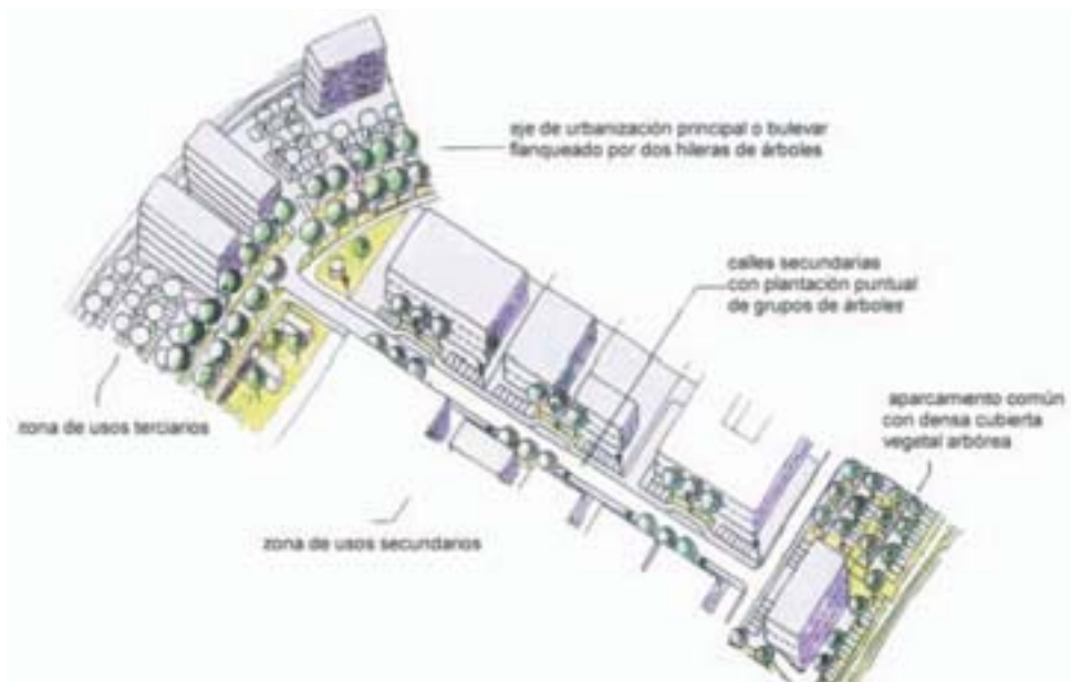
FIGURA 117. Detalle de la urbanización interior (viario y espacios verdes) del Parque Empresarial M1
