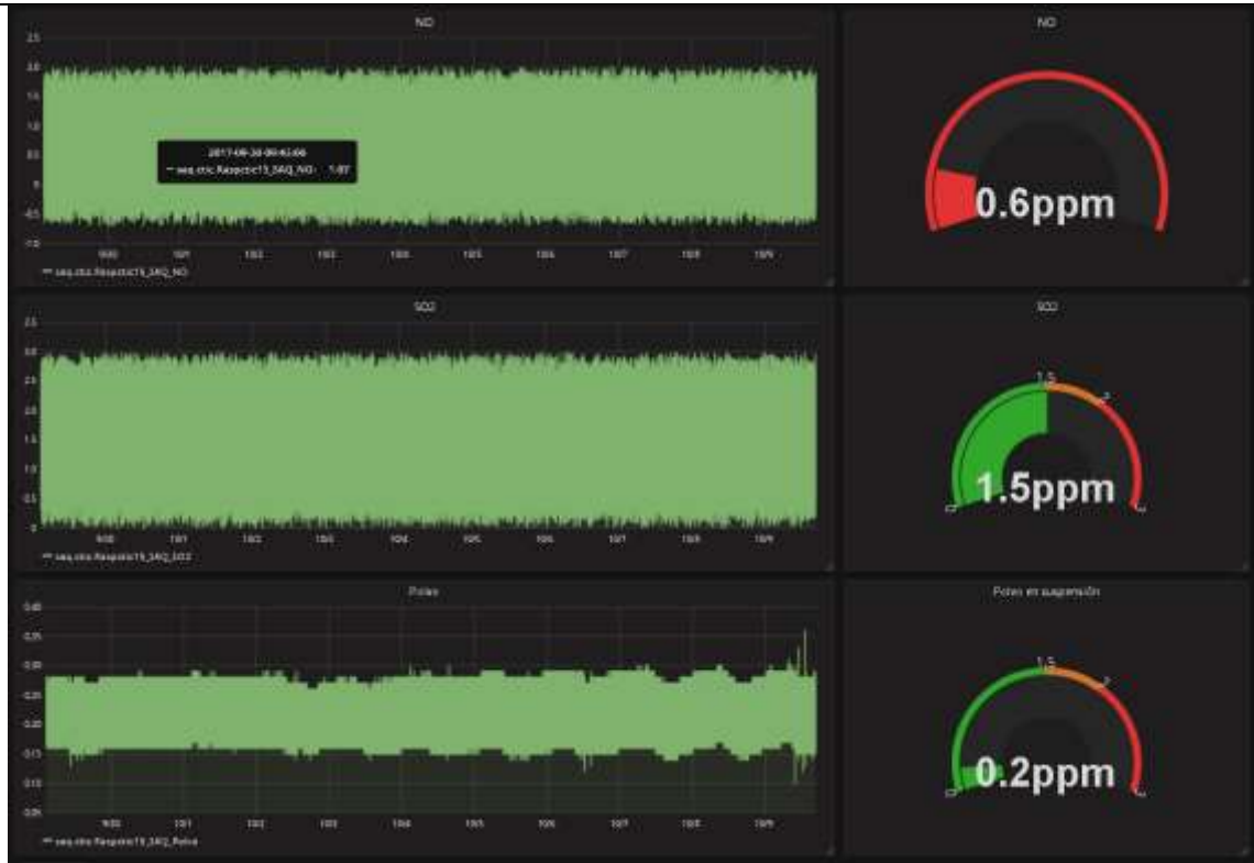
Figura 25: Panel de control con la visualización de los datos recogidos por la mota 15.
