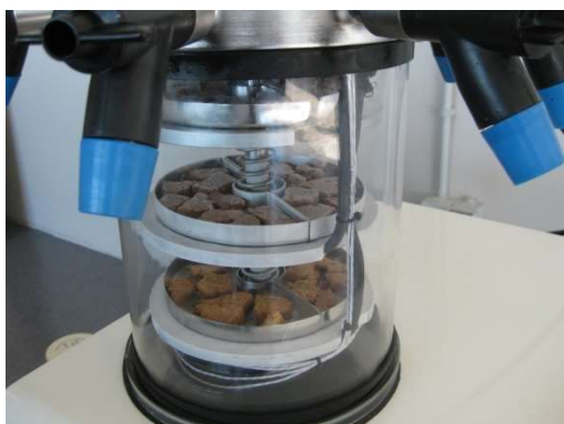
Imagen 23: liofilización de snack de magaya y detalle del snack
