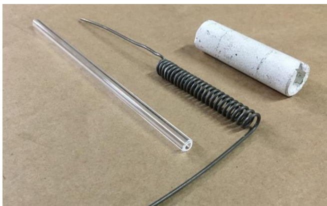
Figura 23. Sistema de fusión mediante resistencia eléctrica.
