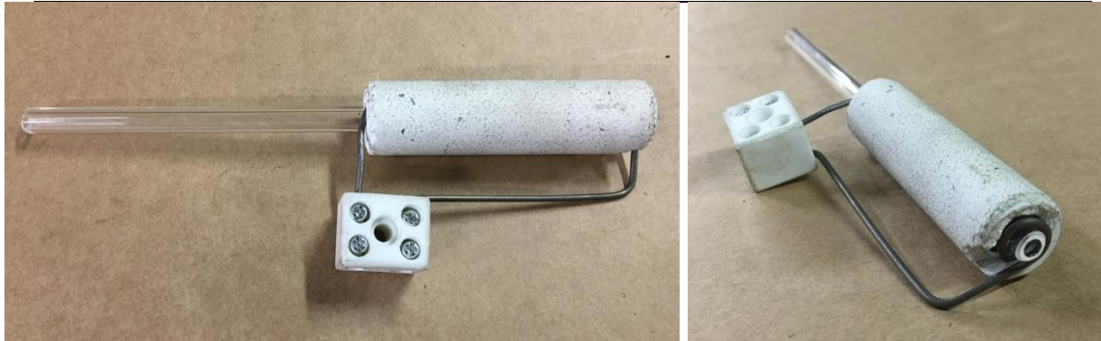
Figura 25. Sistema de fusión mediante resistencia eléctrica.
