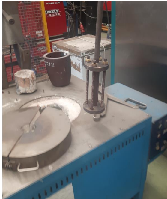
Figura 9. Elaboración de espumas en molde metálico mediante RP-infiltración. Molde acero inoxidable de 5 mm.
