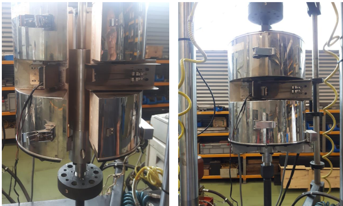
Figura 17. Detalle de los componentes del molde de extrusión en caliente.
