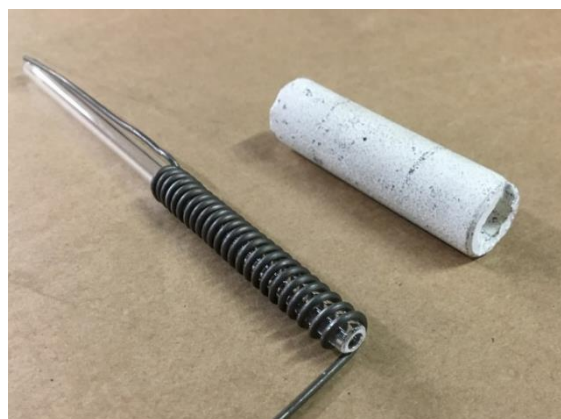
Figura 23. Sistema de fusión mediante resistencia eléctrica.
