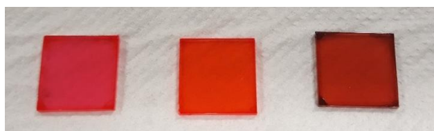
Figura 22. Concentradores solares P14-P16 (de izquierda a derecha)
