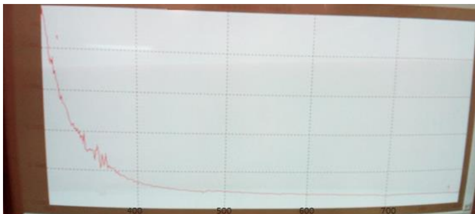
Figura 8. Espectro de absorción de PEG-GMC y disolución bajo luz UV
