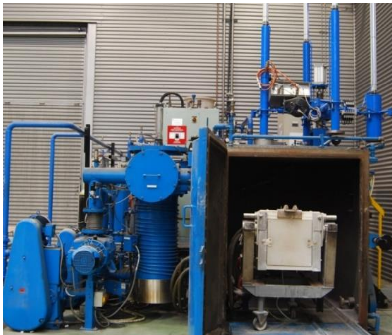
Figura 4. Horno VIM (“Vacuum Induction Melting”) disponible en la planta piloto de fusión a escala semi-industrial de Fundación ITMA.
