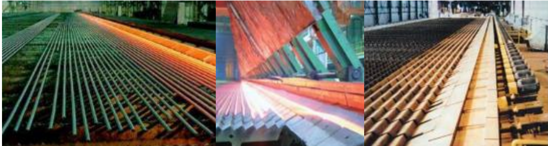
Figura 16. Enfriamiento controlado de aceros avanzados en formato carril. [6]
