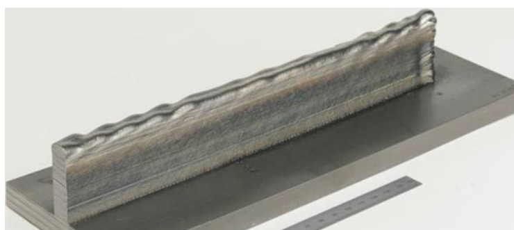
Figura 115. Aspecto superficial después de realizar la soldadura (Prueba 2).
