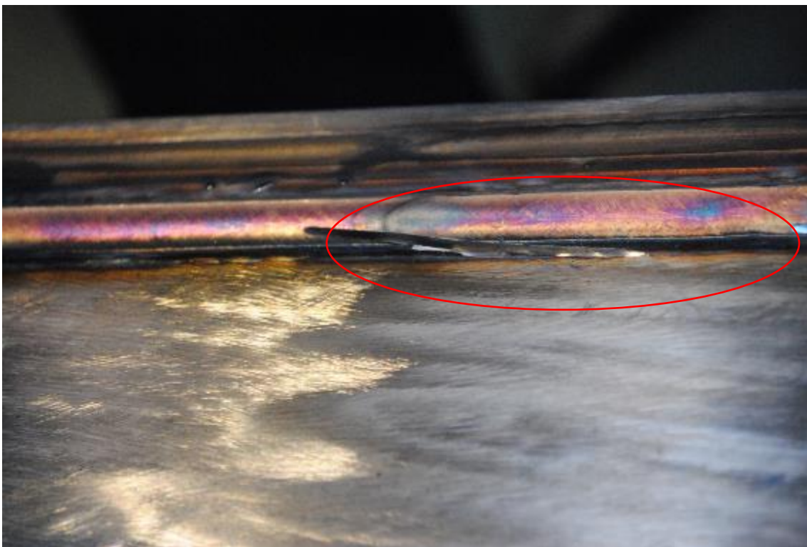
Figura 90. Entalla inducida sobre el material para su análisis termográfico (2).
