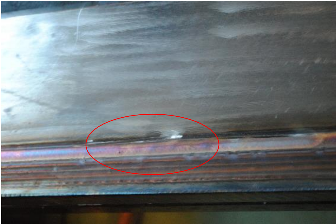
Figura 89. Entalla inducida sobre el material para su análisis termográfico.
