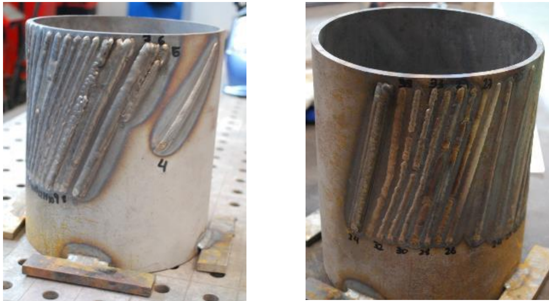
Figura 9. Pruebas sobre tubo St.37.
