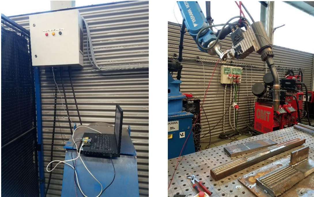
Figura 45. Montaje del sistema de adquisición de datos de corriente (izquierda) y tensión (derecha)
