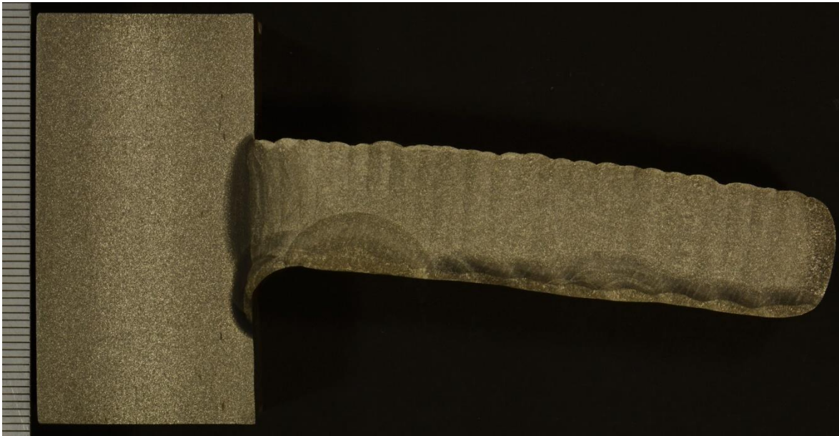
Figura 8. Macrografía de pared plana recocida.
