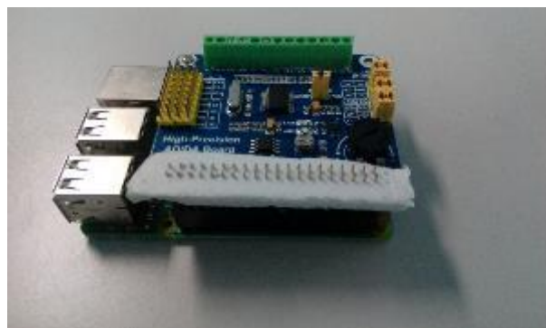
Figura 32. Expansión High Precision AD/DA de la Raspberry Pi.
