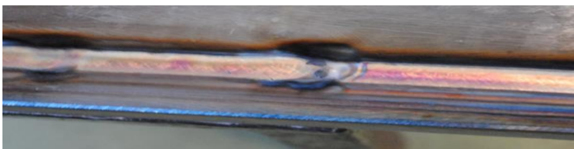
Figura 88. Imagen real de las inclusiones de flux.
