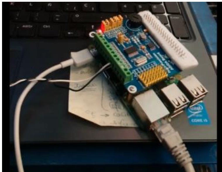
Figura 38. Hardware “Diferencial” acoplado al sensor del panel de alimentación.
