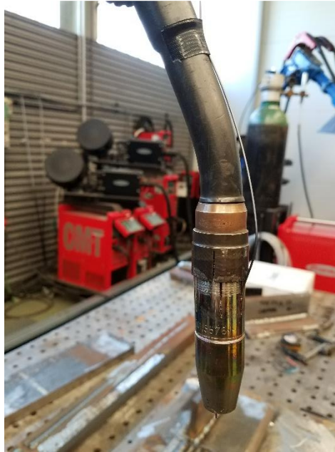
Figura 41. Detalle del montaje del contacto de medida de tensión asociado a la punta del soldador. El contacto de medida referido a la pieza se conecta directamente a la mesa de soldadura, conectada a su vez a la pieza y a la masa del sistema (Figura 48).
