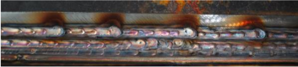
Figura 79. Imagen real de la geometría del cordón
