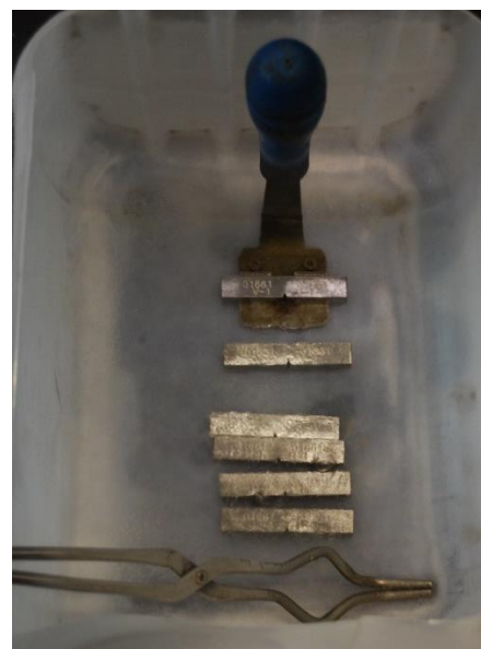
Figura 24. Probetas sumergidas en el baño a -196^{\circ}\text{C}
