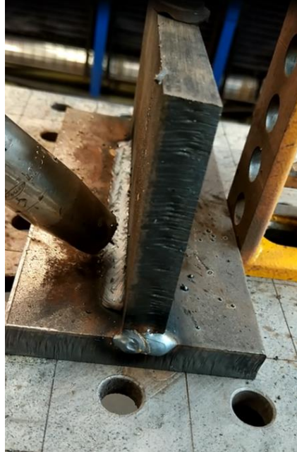
Figura 58. Seguimiento de juntas ComArc prueba1.
