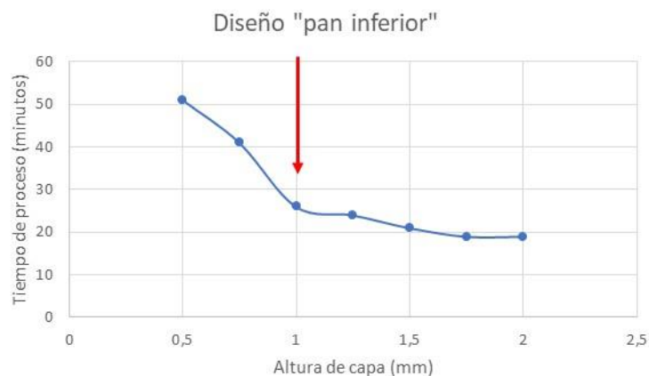
Figura 53. Efecto de la altura de la capa en el tiempo de procesado del diseño “pan inferior”.
