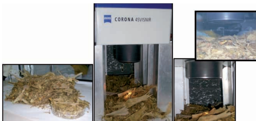
↑ Figura 2. -Equipo NIRS portátil (Host, on-site ).
