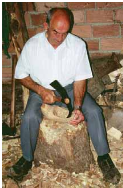
'Azolando' es como se llega a obtener la forma general del exterior de la madreña. La herramienta tiene dos cortes distintos que posibilitan trabajar interior y exterior de la misma. José Fdez. Gallinar. Bezanes. A. L.
