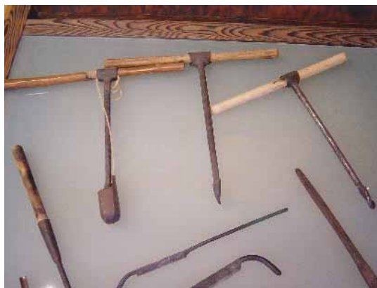
Herramientas del artesano. De izquierda a derecha y de arriba a abajo: llegre , táladrus , raspón de Casu y raseru d'asolar Museo de la Madera. Veneros. A. L.
