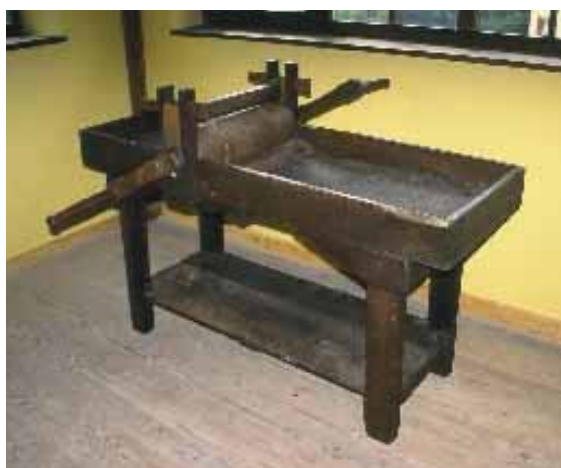
La máquina de rabilar se convierte en el elemento indispensable para conseguir que el ' quesu casín ' alcance el nivel de compactación deseado. Realizar estas tareas a mano sería muchísimo más complicado y laborioso. Ejemplar del Museo de la Madera. Veneros. B. L.
