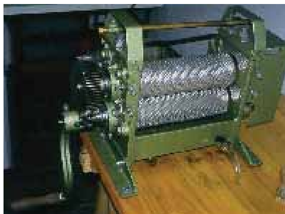
Actualmente la tecnología y la investigación son una ayuda inestimable para el apicultor. Prensa para separar miel y cera. Abantro. B. L.
