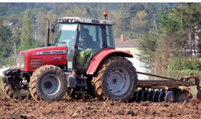
25. Fase de laboreo del suelo mediante grada de discos.
