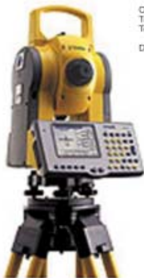
Estación Total Trimble 3306DR con ACU Precisión angular: 10cc Precisión en distancias: 2mm + 2ppm Alcance: 2.500 m Controlador ACU: con software Trimble Survey Controller Medición sin prisma Disponibles en 10cc y 15cc
