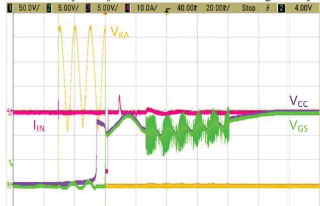
Fig. 6. Arranque del convertidor a 230 V eficaces. Tensión cátodo - ánodo (amarillo), tensión de alimentación de la lógica (azul), tensión de puerta del MOSFET (verde) y corriente de entrada (magenta).
