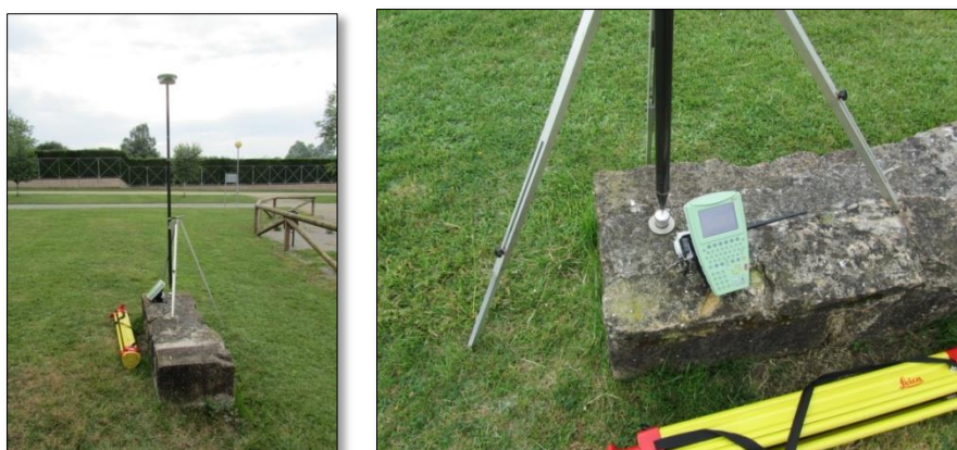
Fig. 5 Determinación de coordenadas precisas de los puntos de control mediante RTK-NTRIP
