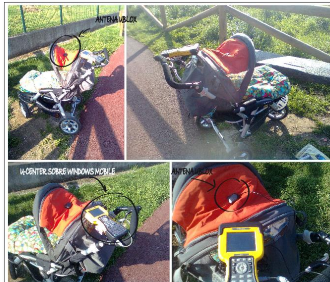
Fig. 11 Ensayo de almacenamiento de datos Ublox sobre Windows Mobile
