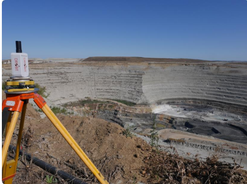
Fig. 11 Base de referencia GNSS en la zona
