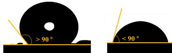
Figura 3.11. Medida del ángulo de contacto de un material hidrófobo (>90 °) y otro hidrófilo (<90 °) con una gota de agua [28].
