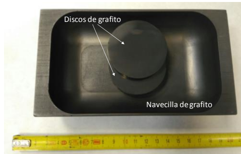
Figura 3.6. Dispositivo utilizado en el tratamiento térmico de las membranas de GO.
