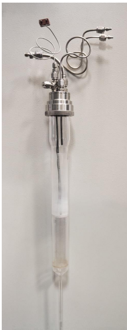
Figura II.9 Montaje del reactor de lecho fluidizado.
