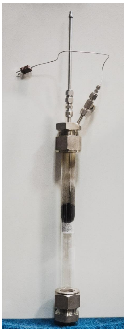
Figura II.15 Reactor de lecho fijo, cargado con catalizador y sorbente, después de un experimento.
