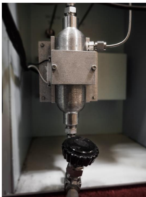
Figura II.10 Depósito de condensación de vapores, con celda Peltier y llave de apertura.
