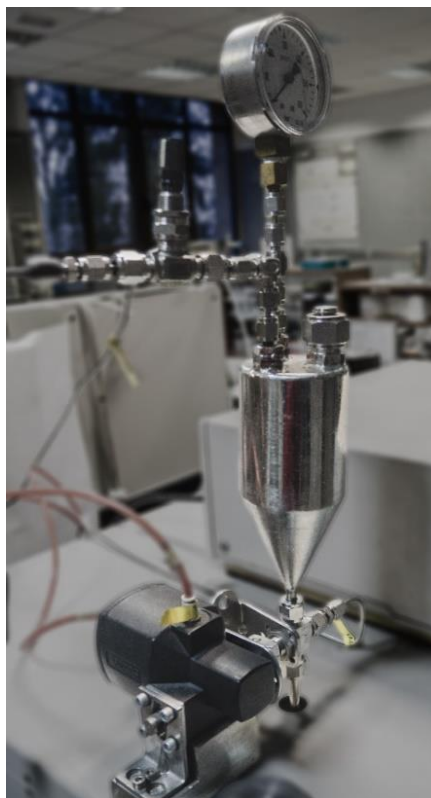
Figura II.14 Sistema de alimentación de sólidos al dispositivo experimental.
