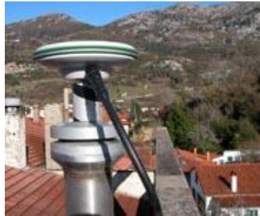
Fig. 6 Antena GNSS de referencia: Fuente: http://rgapa.cartografia.asturias.es/
